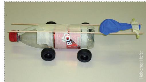
Abb. 2: Luftdruck als alternativer Antrieb
