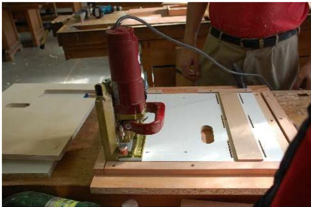
Inzwischen werden die gefrästen Teile mit Hilfe einer weiteren Schablone lamelliert.
