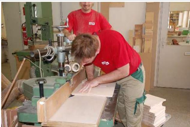
Hier wird der Falz gefräst.
