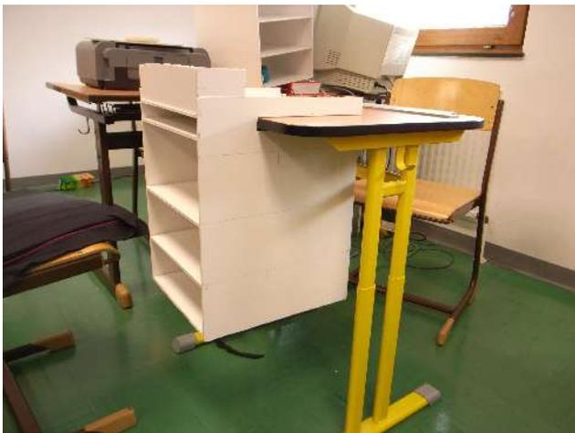
So sieht der fertige Container aus. Die Maße werden jetzt an den tatsächlichen Platzbedarf angepasst. So wird etwa der Teil auf dem Tisch niedriger gestaltet, seitlich werden noch Griffe zum leichteren Transport eingeschnitten, die Höhe wird noch verkleinert.
