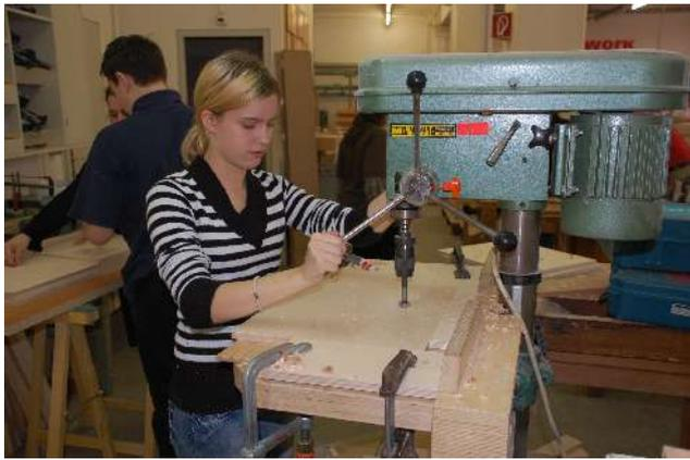
Das hintere Bohrloch für den Griff wird ohne Abstandholz, das vordere Bohrloch mit Abstandholz gebohrt.
