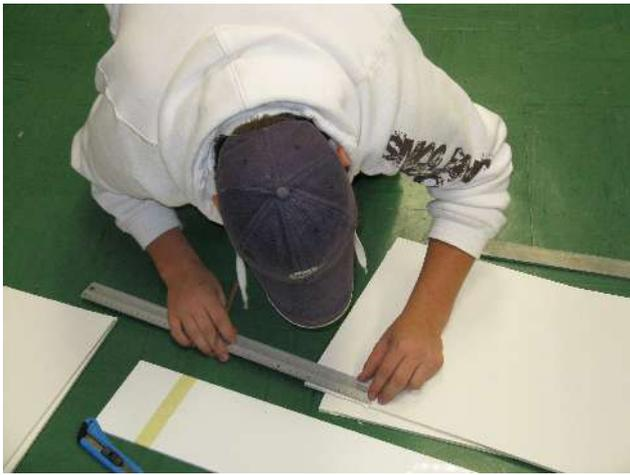
Auf Plexiglas-Schneideunterlagen werden mit Eisenlineal und Stanleymesser die ersten Teile zugeschnitten.
