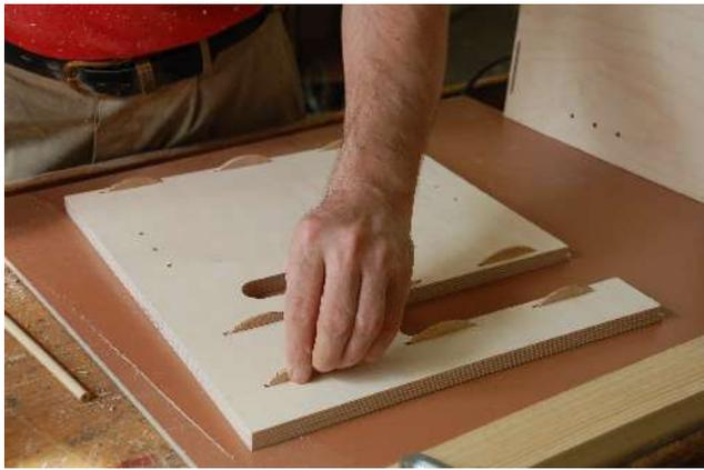
Probeweise wird ein Container zusammengesteckt, um die Rückwand genau ausmessen zu können.
