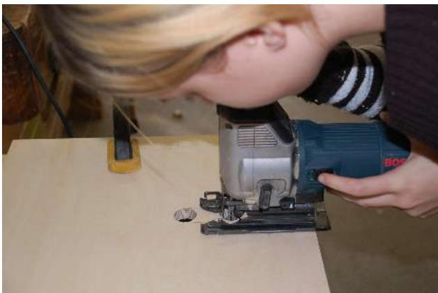
Die Bohrlöcher werden mit dem Lineal verbunden, entlang der Linie wird mit der Stichsäge ausgesägt.
