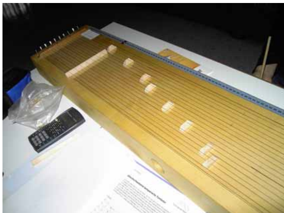
Abbildung 1: Monochord mit Einlageblättern und Stegen
