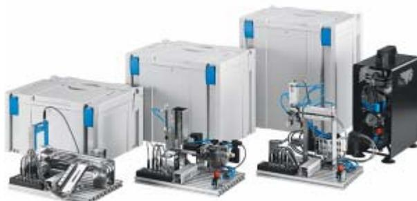
Die Steuerung der Stationen erfolgt über das Simulations- und Steuerprogramm FluidSIM® in Verbindung mit einem EasyPort. Hier werden die Sensorensignale von den Stationen eingelesen und die Antriebe der Stationen angesteuert. Jedes Modell wird mit der USB-Schnittstelle am PC verbunden.
