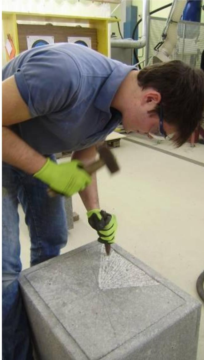
Die Oberflächen der Sitzwürfel in unterschiedlichen Steinarten werden nach der Formatierung mit der Brückenkreissäge nach allen Regeln der Handwerkskunst bearbeitet und gestaltet - gespitzt, gestockt, poliert, geschliffen.....
