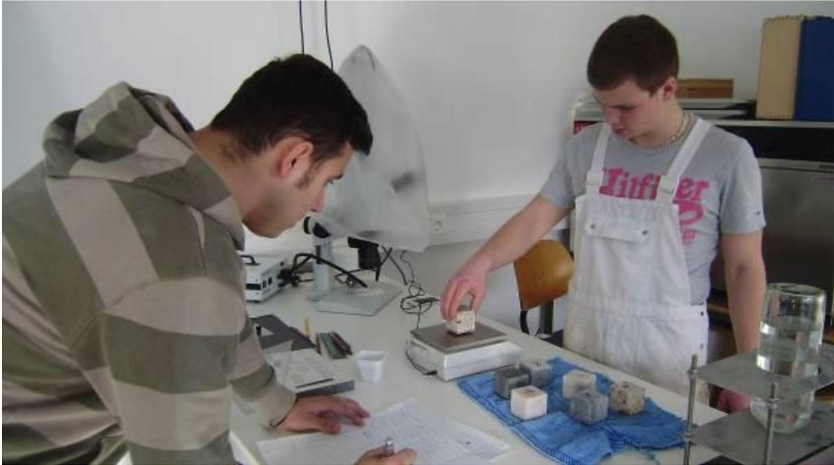
Im Labor werden genaue Untersuchungen im Hinblick auf die mineralische Zusammensetzung, die Wasseraufnahmefähigkeit sowie die Gesteinsdichte durchgeführt.
