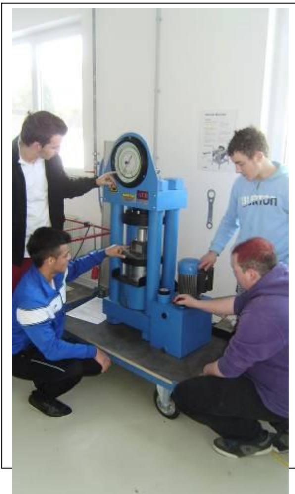
Mit den an unserer Schule normgerechten Labor-Prüfgeräten werden die Druck- und Biegezugfestigkeit sowie Abrieb nach BÖHME an den verwendeten Steinarten getestet und fachgerechte Prüfberichte erstellt.
