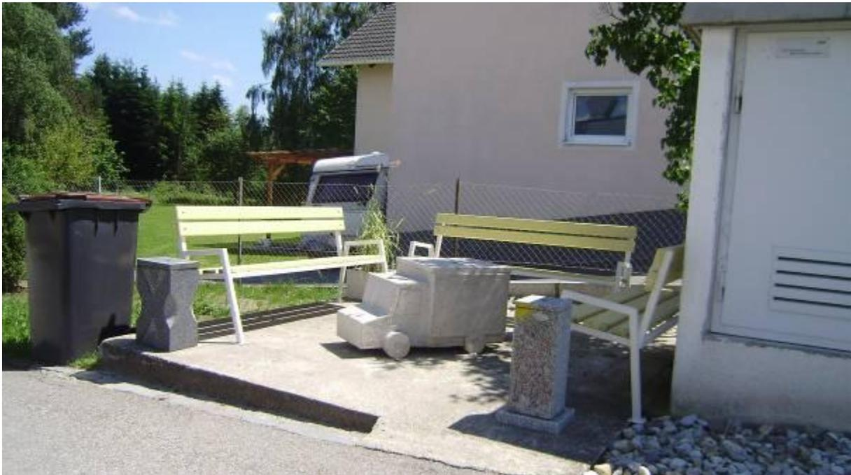
Stein-STELEN, ein „Müllwagen“ aus Stein – sie alle haben ein Innenleben: unter dem jeweiligen Deckel befindet sich ein Müllsammelbehälter, im Deckel ist ein Loch, damit man auch ohne Anheben des Deckels den Zigarettenstummel entsorgen kann
