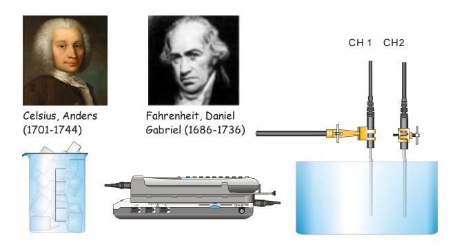
Wir verwenden 2 Temperatursensoren, ermitteln die Temperaturkurve beim Abkühlen und entwickeln eine Umrechnungsformel von Celsius auf Fahrenheit und umgekehrt.
