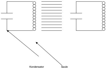
Frequenz wird durch Spule und Kondensator festgelegt. Sender und Empfänger haben die gleiche Frequenz. Welle modulieren-Sender und demodulieren-Empfänger (Eine Nachricht mitgeben)
