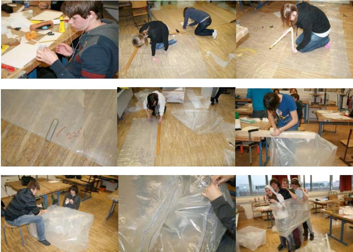
Übertragung der Maße auf die Folie, Verarbeitung und erste Tests mit Druckaufbau.
