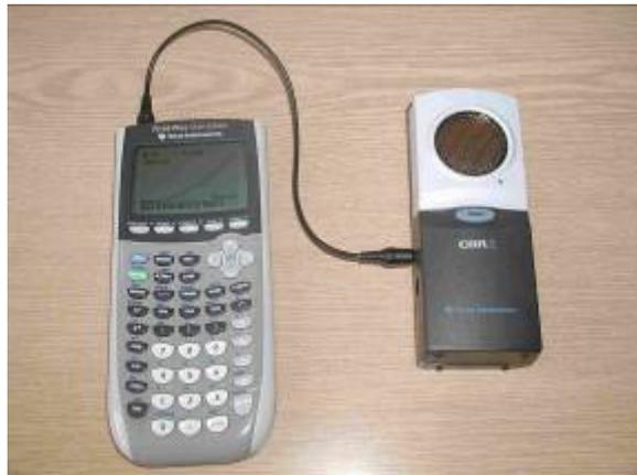
Abbildung: Grafikrechner TI-84 mit dem Ultraschallsensor CBR
