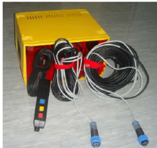
Rückseite des MNI-Sportzählers mit aufgerollten Anschlusskabeln für Lichtschranken und Starter
