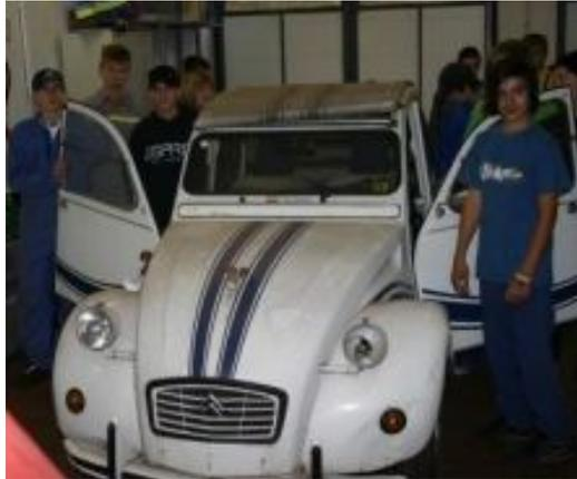
Da stand nun die flughafne Ente in unserer neu adaptierten Werkstätte. Blasses Blechkleid, verrostet, wahrlich mit einem Fetzendach, abgefahrenen Reifen, defekten Bremsen, kaputten Achsschenkeln, zeretztem Interieur Karosseriedurchrostungen und Beulen an allen Ecken und Enden.
