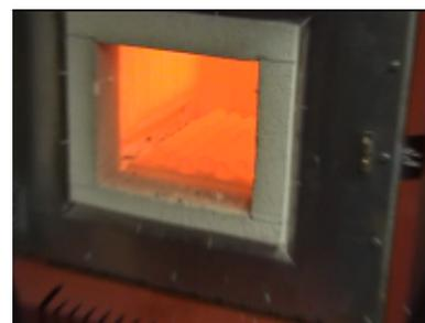
**Abbildung 20:** Erwärmen der Teile im Härtofen
