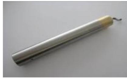
**Abbildung 16:** Handentgrater mit Schnellwechselsystem
