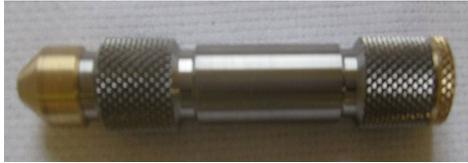
**Abbildung 15:** Handentgrater mit Materialkombinationen
