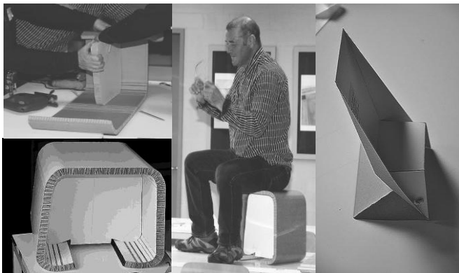
Ein Sitzmöbel auf die Schnelle: Zerlegbarer Hocker aus nur zwei Teilen, Konstruktion aus biegefesten Waben- und Sandwich-Strukturen nach Vorbildern in der Natur / Falt-Modell „Plicio“ Uni Linz nach dem Vorbild von Käferflügeln (Workshop Mag. E. Malota – BRG Baden)
